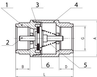
Клапан состоит из составного латунного корпуса (поз. 1 и 4), выполненного из латуни марки CW 617N по стандарту EN 12165, что соответствует марке ЛС59-1 по ГОСТ 15527-70, в котором расположен подвижный золотник, состоящий из латунных штока (2) и диска (6), а также нитрил бутадиенового уплотнительного кольца (3-NBR). Возврат золотника в седло обеспечивается пружиной (5-AISI 306).
